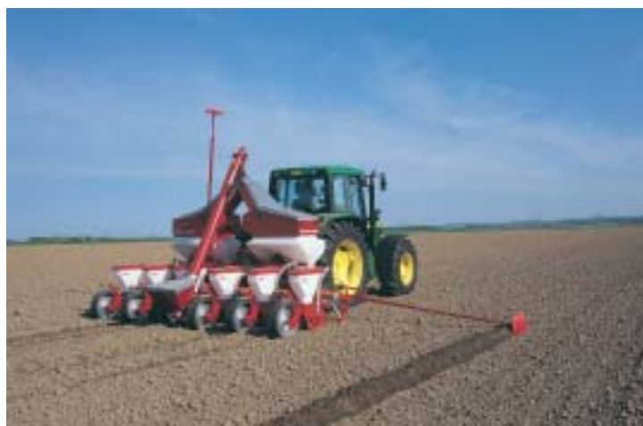
Fig. 1 - Semeador - fertilizador OPTIMA NT, de 6 linhas, para milho; quadro telescópico; tremonha (desmontável) para adubo, com sem-fim de carga
