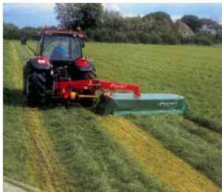
Gadanheira-Condicionadora Montada, Modelo 2524 , de 2,40m larg. de trabalho
