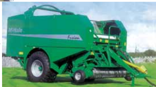
Enfardadeira-Plastificadora FUSION Com apenas 1 operador, enfardamento e plastificação numa só passagem: 50-60 fardos por hora
