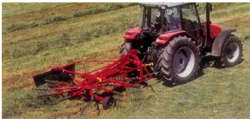
Juntador-Encordoador de Feno, Montado, 9035 , c/ 3,5m de larg. de trabalho. Pode ser accionado por tractores de baixa potência.
