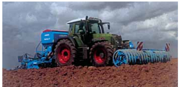
Fendt 718 Vario 700 VARIO, de 130cv / 96KkW a 180cv / 132kW 712V – 714V – 716V – 718V
