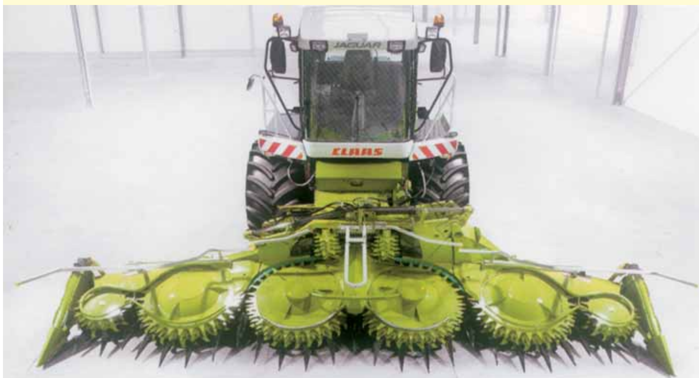
COLHEDOR DE FORRAGENS AUTOMOTRIZ JAGUAR 900, com motor V8 de 458 kW / 623 cv e frente para milho independente do número de linhas "ORBIS": larg. de trabalho até 7,5m
