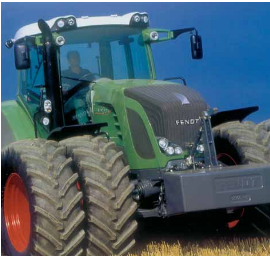
Tractor FENDT 936 VARIO - o mais potente (269 kW / 366cv) mais rápido (60km/h) e mais sofisticado do mundo
