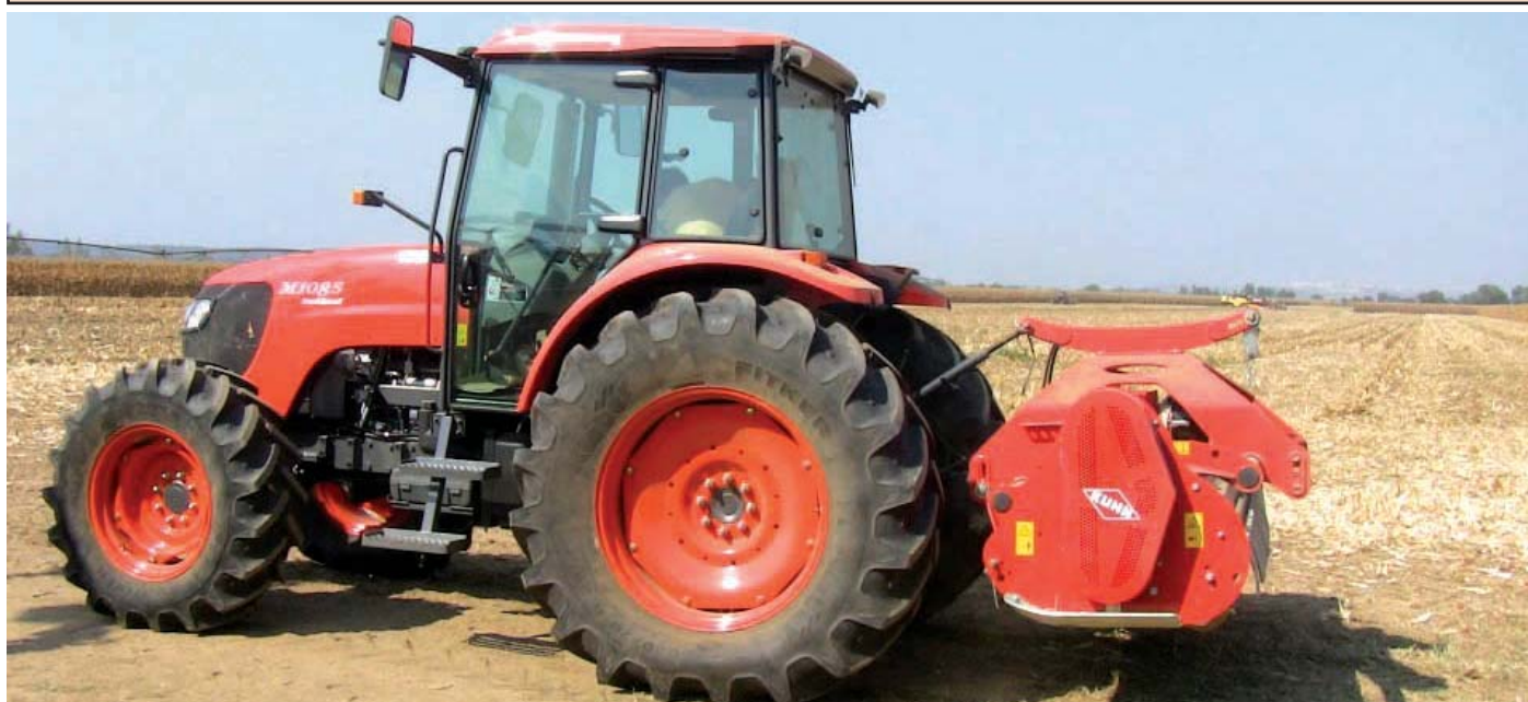
TRACTOR KUBOTA M 108 S, com destroçador KUHN BPR 305, de 3 m de largura, reversível (montagem atrás ou à frente)
