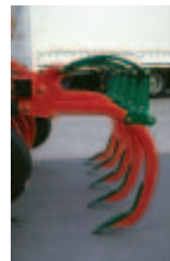
Fig. 2 - Pormenor dos dentes e das robustas molas de segurança “non stop”, de lâminas de aço
