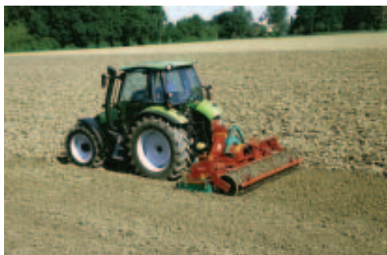
Fig. 3 - Rototerra com rolo “packer”
