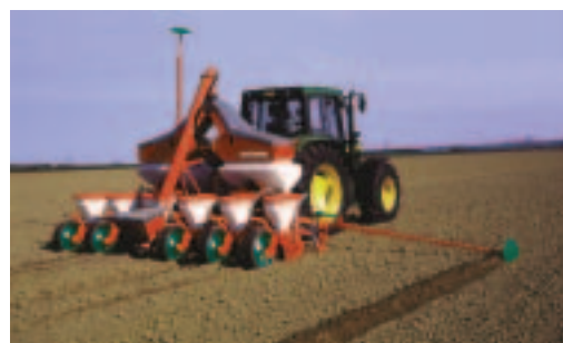
Fig. 4 - Semeador - fertilizador OPTIMA NT, de 6 linhas, para milho; telescópico; tremonha (desmontável) para adubo, c/ sem - fim de carga
