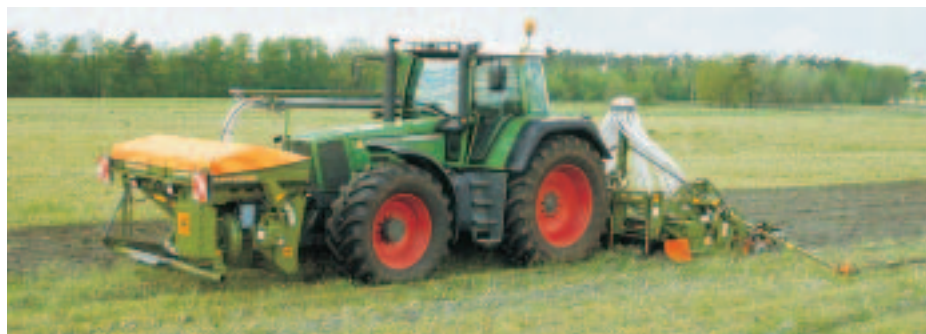
Tractor Fendt Vario, com Combinado Amazone de 6m de largura (Rototerra KG 603 - 2 + Semeador Airstar Profi)
